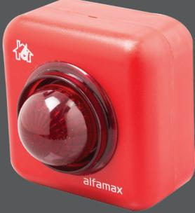
**TANIM:** C-1006 iki parçadan oluşan kırmızı renkli kasası sayesinde kolay monte edilebilen Flaşörlü elektronik bir sirendir. Cihazın monte edildiği yerden itibaren, 3 metre mesafede 85dB gücünde ses çıkışı vardır. ABS plastikten imal edilen kasanın yapısı sayesinde, cihazın kablo bağlantıları tabanına oturtulmadan önce yapılabilmektedir.
