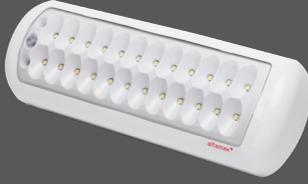
**TANIM:** Bright-X acil aydınlatma armatürü can güvenliği için acil aydınlatma armatürü olarak kullanılır. Alfamax Bright-X duvara ya da tavana monte edilebilir. 3 adet AA Ni-Mh pil ile 3-5 saat aydınlatma kapasitesine sahiptir. Alfamax Bright-X genel elektrik kesintisi, yangın/deprem vb. Durumlarda otomatik olarak devreye girer.
