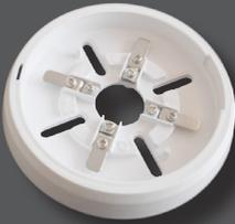
**TANIM:** AXDB-01 Standart Dedektör Tabanı Adresli ve Konvansiyonel Yangın algılama Sensörlerinin Bağlantı ekipmanıdır. AXDB-01 Standart Dedektör Tabanı, Alfamax Markalı duman, ısı ve kombine dedektörlerinin iletim hattına kolay bir şekilde montajını sağlayan ergonomik bir aparatır. Yanmaz ABS malzemeden imal edilmiştir. Kullanım kolaylığı sayesinde, kablo bağlantıları yapılmadan istenilen yüzeye montajı mümkün kılar.
