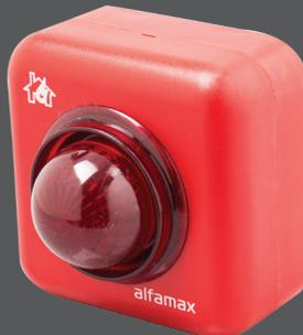
**TANIM:** C-1006 iki parçadan oluşan kırmızı renkli kasası sayesinde kolay monte edilebilen, elektronik bir sirendir. Cihazın monte edildiği yerden itibaren, 3 metre mesafede 85dB gücünde ses çıkışı vardır. ABS plastikten imal edilen kasanın yapısı sayesinde, cihazın kablo bağlantıları tabanına oturtulmadan önce yapılabilmektedir.
